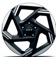
17-palcové disky kolies z ľahkých zliatin (pneumatiky 225/45 R17) Sport / Platinum
